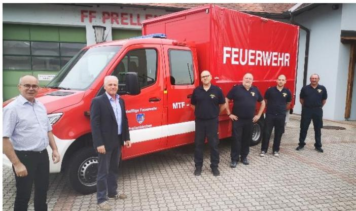
**Technische Daten:** Länge 7,20m, Breite 2,65m, Höhe 3,20m, Diesel mit Addblue 190PS, selbstaufrollende Plane, Allrad, hydraulische Ladebordwand
